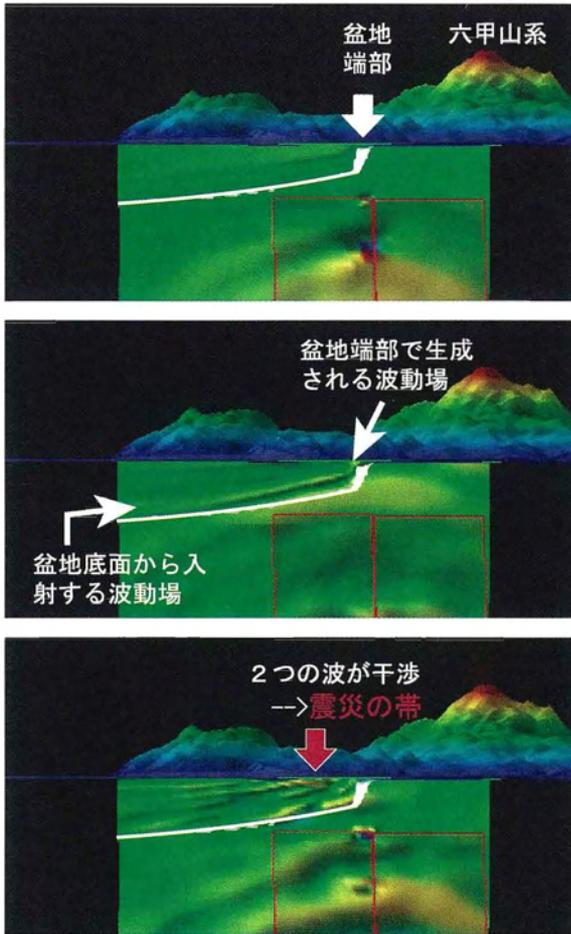
図14 1995年兵庫県南部地震の数値シミュレーション結果。北東方向から見た、ポートアイランド付近の地下断面における波動伝播の様子を示している。軟弱な盆地に入射して増幅された地震波と、盆地端部で二次的に励起された表面波が干渉して「震災の帯」ができたことが分かる。赤線は断層面を示す。
