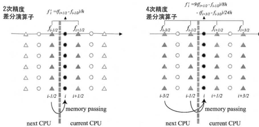
図10 2次精度および4次精度の差分演算子を用いた場合の並列計算において、CPU間通信が必要となる格子点の位置関係。黒円で示した点の差分値を求めるために値が必要となる格子点を灰色三角で示した。2次精度においては各CPUに割り当てられた領域に接する格子のみがCPU間通信の対象となる。4次精度の場合は、さらにもう一格子内側まで対象となり、通信量が2倍になる。
