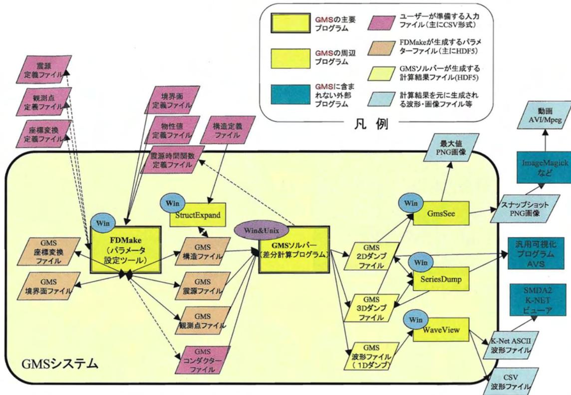
図6 GMSを構成するプログラム（ツール）群及びそれらを繋ぐファイル群を、計算の流れに沿って示したブロック図。パラメータ設定から、実際の計算、フィルター処理、計算結果の表示など複雑で多岐な処理が、HDFファイルにより橋渡しされている。
