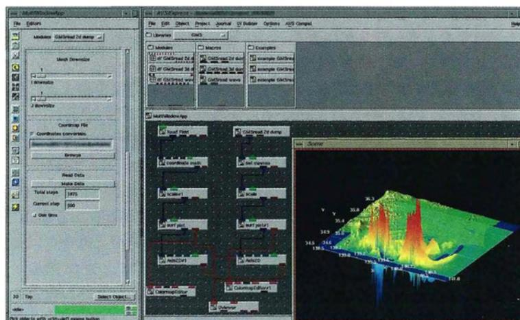
図13 GMS が生成する HDF5 形式の計算結果を AVS で直接読み込むモジュールおよび AVS による可視化例。
