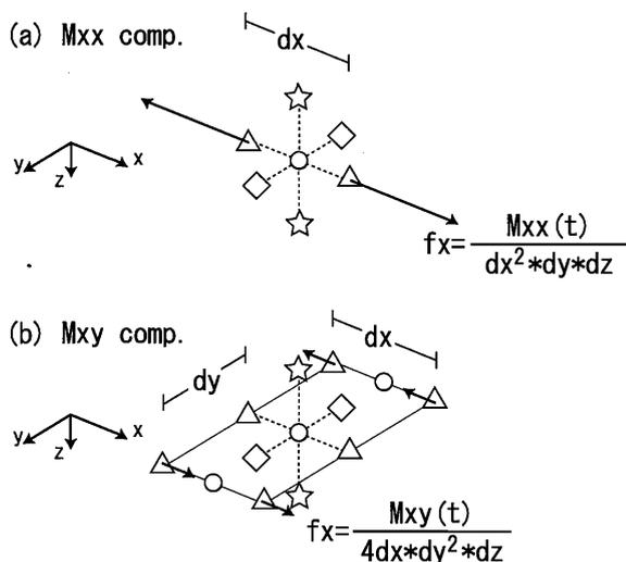
図5 Graves (1996) により提案された断層型点震源の定式化において, モーメントテンソル  $M_{xx}$  及び  $M_{xy}$  を実現するために各格子点に加えるべき力。
