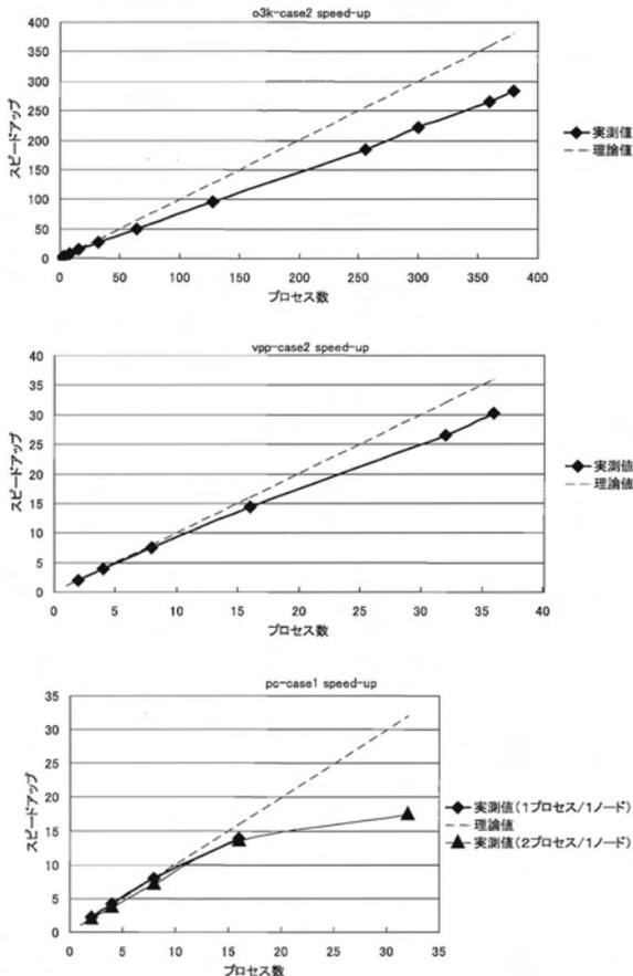
図12 並列化によるスピードアップの比較。(上) SGI 社製 Origin3800, (中央) 富士通社製 VPP5000, (下) PC クラスタによる並列化効率試験の結果。
