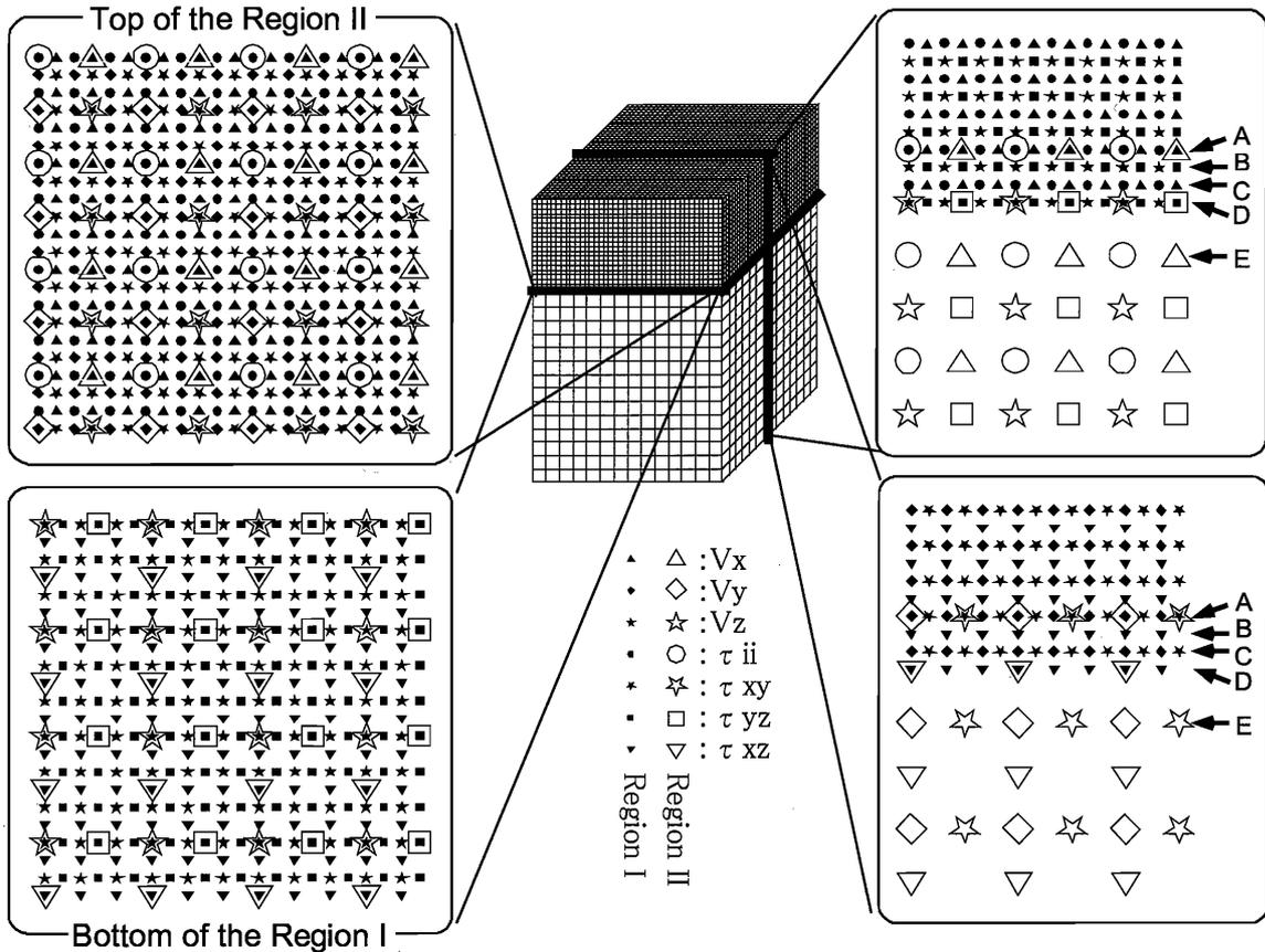
図2 (中央) 計算に用いる不連続格子。(右) 不連続格子の垂直断面。領域Iと領域IIの接続部分で、内挿のために格子が重なっていることが分かる。(左) 領域IIの最上面 (A面) と領域Iの最下面 (D面) における不連続格子の水平断面。
