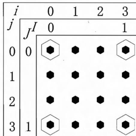
図4 内挿により領域Iと領域IIを接続するD面の格子点配置。(I, J)と(i, j)は内挿の際に用いる格子点番号で、図3に示した線形内挿関数から導かれる重み(表1)で内挿される。
