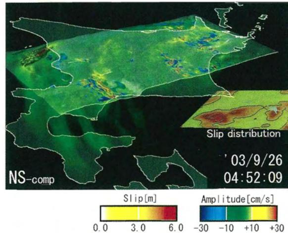
図15 ボリュームレンダリングによる2003年十勝沖地震のシミュレーションの可視化例。長周期地震動によるスロッシングにより石油タンクが被害を受けた勇払平野や、十勝平野、根釧原野などにおいて、深い堆積層に地震波がトラップされている様子が分かる。
