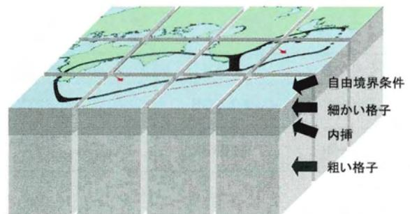
図11 並列計算の際の領域分割法。水平方向にのみ分割を行うことにより、格子点間隔が異なる領域I・領域II、自由境界条件、内挿処理など計算量が異なる各種の処理が、各CPUに同等に分配され、効率的な並列計算が実現される。
